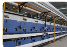
▲ 五层干燥新型窑炉
